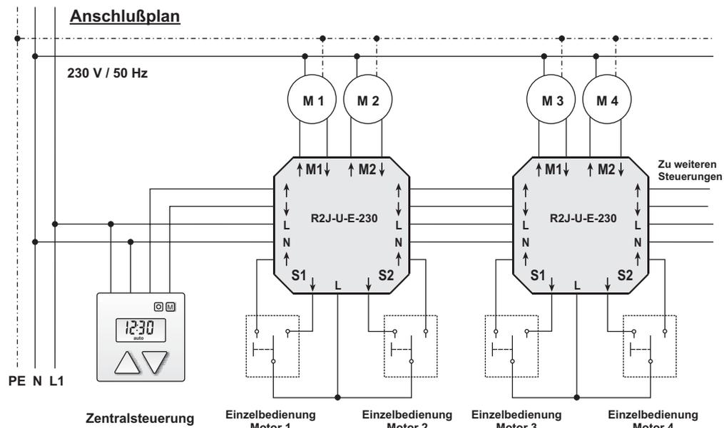
**Wichtig!** Sollte als Zentralsteuerung eine Zeitschaltuhr mit einem Sonnen-/Dämmerungssensor eingesetzt werden, muss an allen Steuerungen R2J-U-E-230 die Betriebsart "ohne Selbsthaltung" eingestellt werden.
