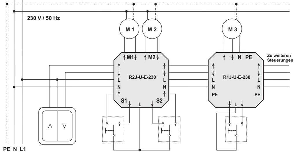
**Montagehinweise:** Mehrere Motorsteuerungen können laut den Anwendungsbeispielen nacheinander geschaltet werden. Die maximale Anzahl der anzureihenden Motorsteuerungen ergibt sich aus der Summe der einzelnen Motorströme. Bei einer zu große Anzahl der Motoren (ab eine Summe der Motorleistungen von ca. 2kW) wird empfohlen, eine neue Netzeinspeisung für die weiteren Motorsteuerungen vorzunehmen, um eine bessere Verteilung der Motorströme auf mehrere Stromkreise zu erreichen.
